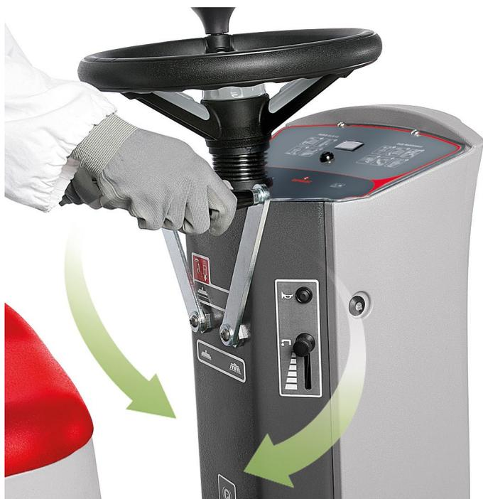
Nella versione manuale il tergilavaggio e il basamento sono controllati da due leve indipendenti offrendo la massima semplicità di uso anche da parte di operatori non specializzati. Innova M è disponibile nelle versioni da 60, 65, 75, 85 e 100 cm di pista di lavoro.
