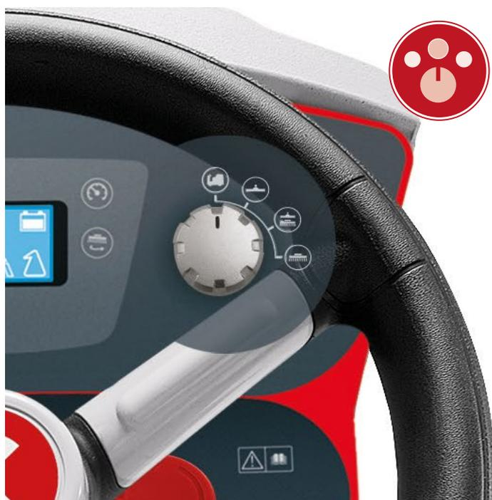
La versione automatica adotta il **selettore di programmi di lavoro** che offre un approccio estremamente intuitivo. Esso consente di scegliere tra 4 programmi di lavoro preimpostati: Trasferimento, Asciugatura, Lavaggio/Asciugatura, Solo lavaggio.
